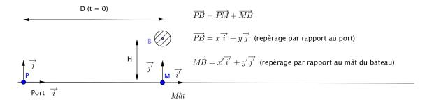
Une balle est lâchée du haut d'un mât d'un bateau qui navigue sur une mer "calme" à une vitesse constante  $v_e$  par rapport au port. On suppose que le port est un référentiel galiléen.
