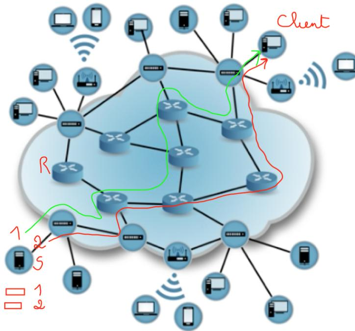
Les **routeurs** R (symboles avec 4 flèches comme des carrefours) font la circulation des paquets, de manière autonome à l'aide d'algorithmes
