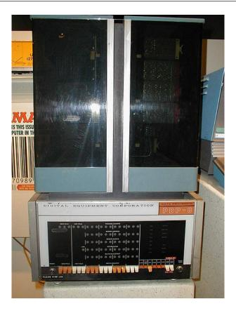
Les transistors ont remplacé les tubes à vide, la taille des ordinateurs a diminué on parle maintenant de mini-ordinateurs (la taille d'un réfrigérateur pour le PDP-8 de Digital Equipment (image ci-dessus))
